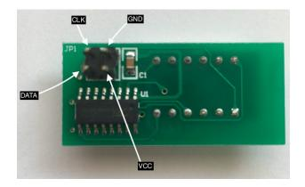
**Display Pins** PCB header (H2) pin **GND** 1 GND CLK 2 CLK
