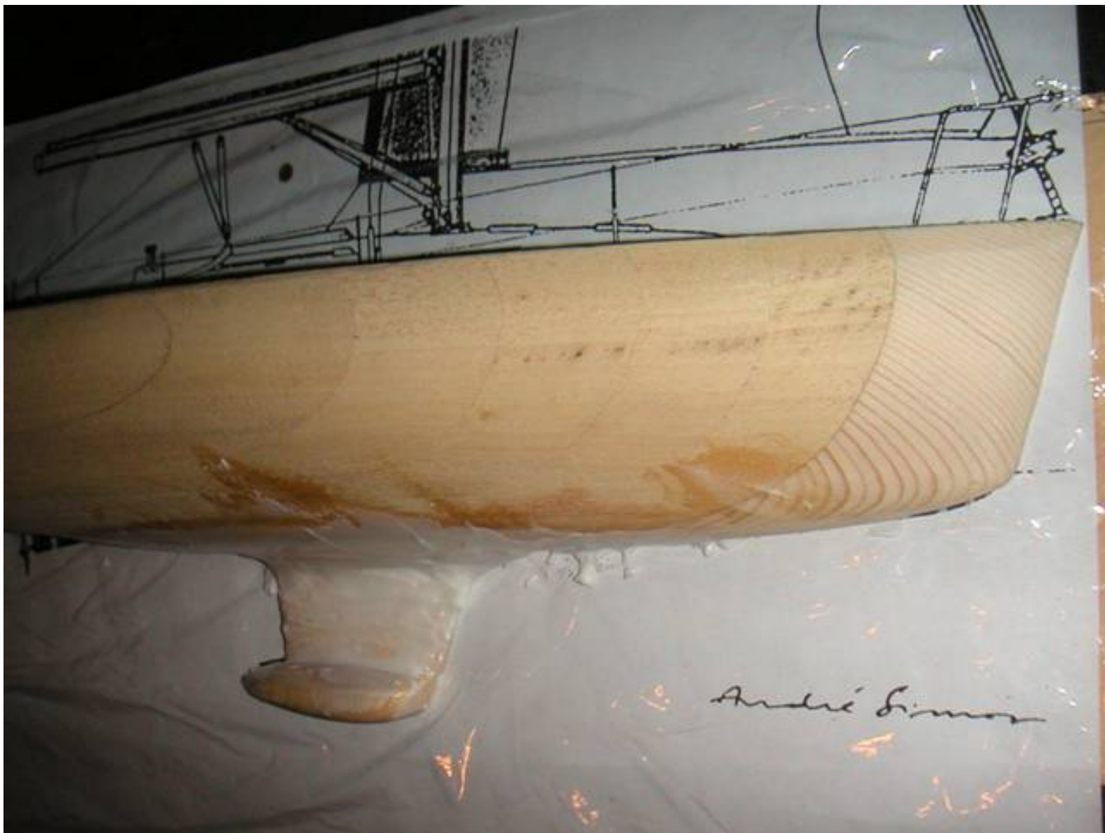
assemblaggio controllo delle dimensioni e stuccatura (resina epossidica e microsferi)
