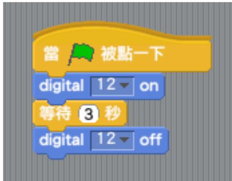
如果我們要在 3 秒後熄滅 LED 燈，那就在 delay 3000 毫秒後，設腳位為 LOW 即可。
