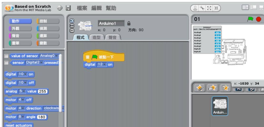
我們可以透過 Arduino 開發環境，用 C 語言來寫程式控制 MeArm，也可以在圖形介面用拖拉方式產生程式，現在我們開始第一堂課：“給我一盞燈”
