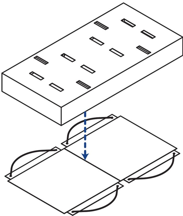
14 Colocar la estructura con nylon encima de los paneles
