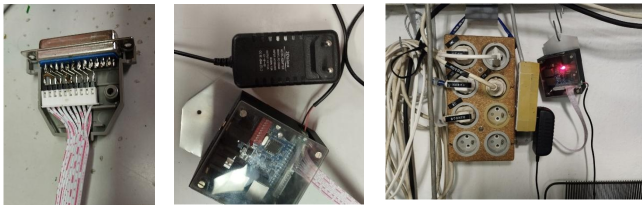
Obrázky 26. Paralelní konektor do switch boxu 27. řídicí krabička DMX s trafem a uchem 28. nainstalovaný a ozkoušený switch box
