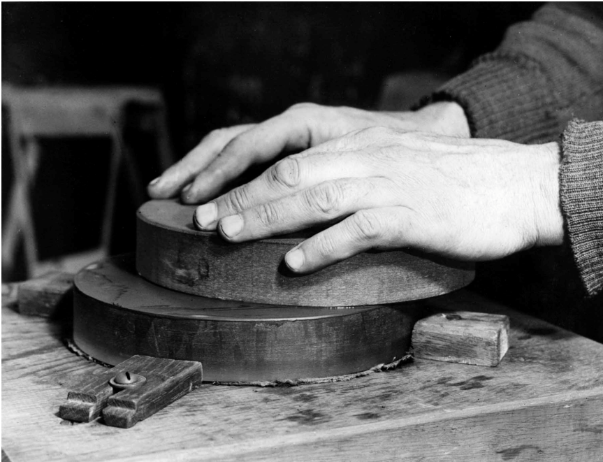
Fig. 23. – Doucissage d'un miroir de 200, amplitude de la course normale (atelier de la Commission S. A. F.)
