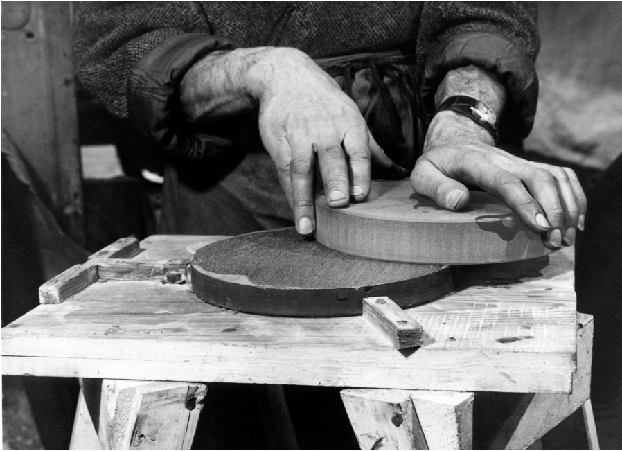
Fig. 19. – Ebauchage d'un miroir de 200 (atelier de la Commission S. A. F.).
