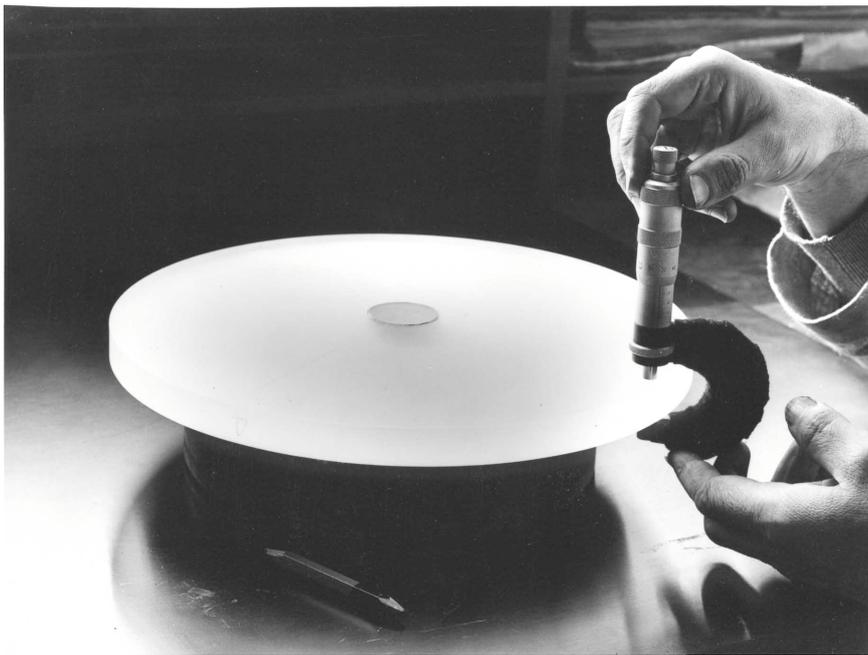
Fig. 96. – Vérification au parallélisme au palmer. (Atelier de la Commission S. A. F.)
