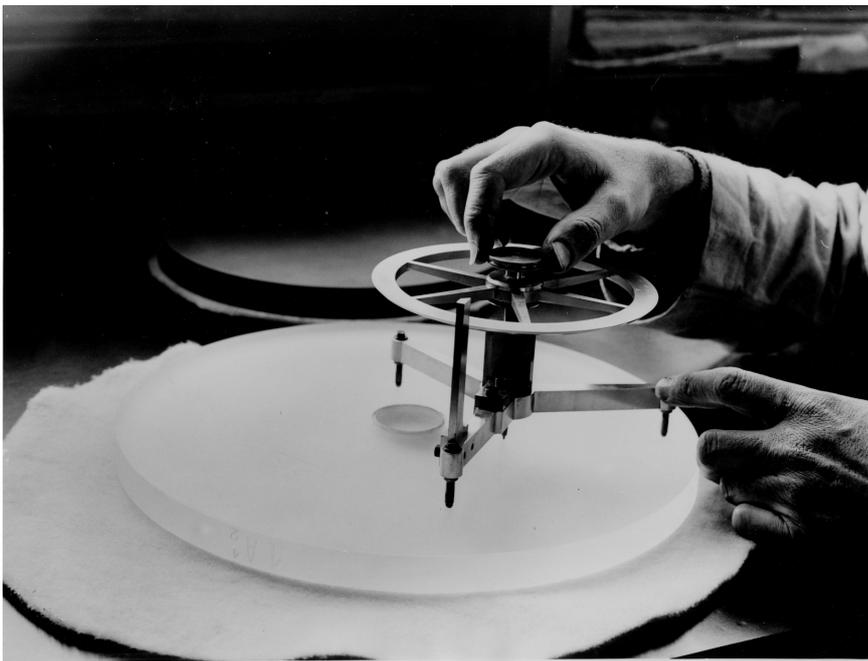
Fig. 99. – Le sphéromètre qu'employait Léon Foucault posé sur une lame de 300.
