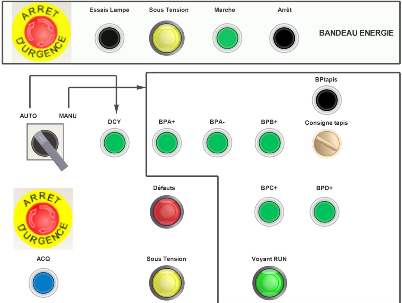
Le mode manuel est câblé : les boutons poussoir permettant de piloter les électrovanne et moto-réducteur dans le désordre ne sont pas reportés en entrée du micro-contrôleur, cela permet d'économiser sur le nombre d'entrée et aussi, en cas de défaillance de la carte d'entrée, de pouvoir tout de même piloter le système.
