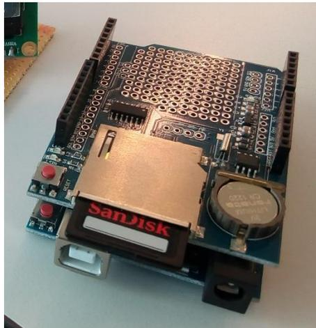
Abbildung 18: Material - Data Logger Shield
