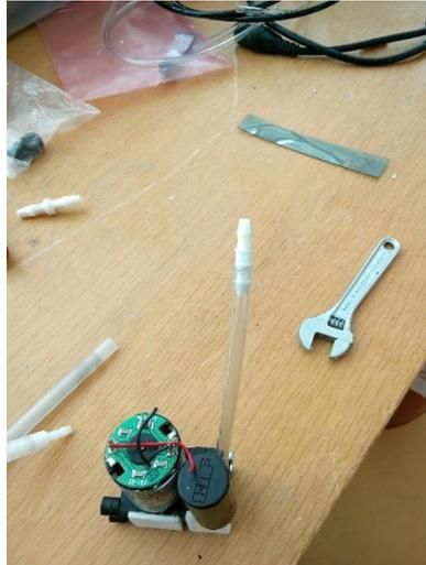
Abbildung 16: Pumpe mit kritischer Düse
