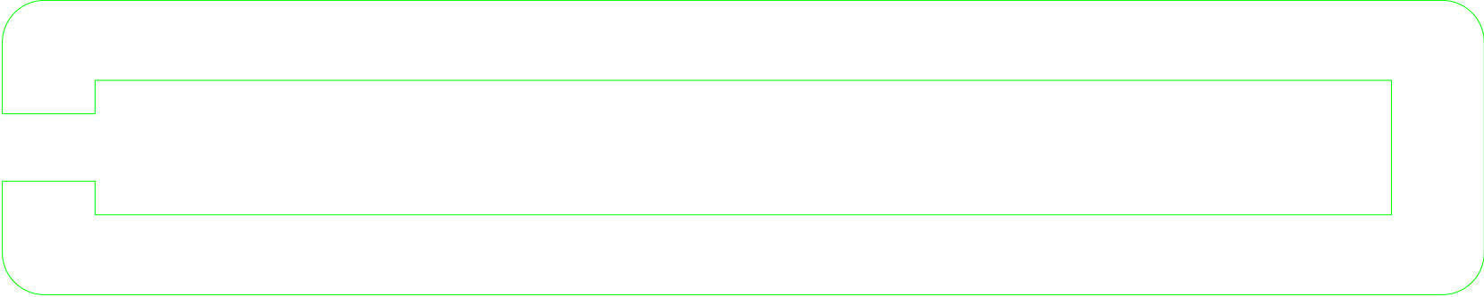
FUSTA 3,5~4 mm (quantitat 2 o 3) tapa intermitja, donarà alçada a la base i el forat de l'esquerra es per passar el cable
