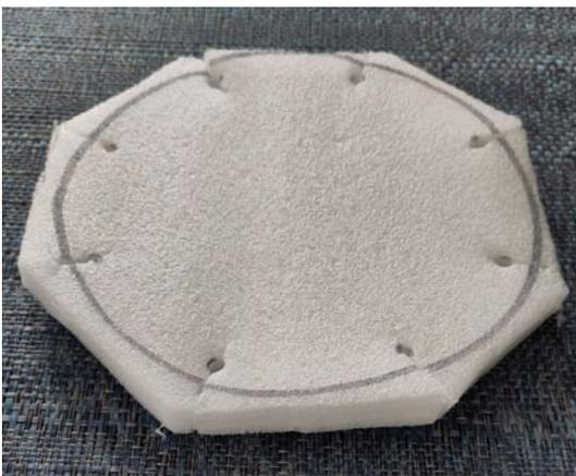
Ich verwendete pro Gehäuse  $\frac{3}{4}$  eines Pakets des angegebenen Dämpfungsmaterials, also eine Menge für etwa 15 l. Am einfachsten war es, die grossen Matten in mehrere kleinere Teile zu schneiden (oder zu reissen) und das Gehäuse gleichmässig damit zu füllen. Lediglich der Raum direkt hinter dem Tieftöner blieb frei.
