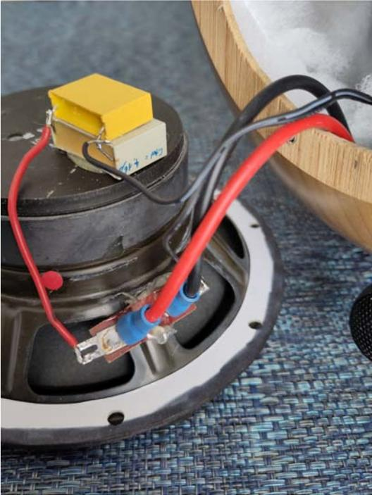
Bevor der Tieftöner ins Gehäuse eingesetzt werden kann, müssen die Leitungen von den Anschlussklemmen und zum Hochtöner mit ihm verbunden werden, siehe Schaltschema im Schritt 9 und Bild oben. Einige der Verbindungen (am Kondensator und am Hochtönerkabel) sind gelötet. Für den Anschluss der dicken Leitungen am Tieftöner benützte ich Quetschverbinder für 6.3 mm-Steckfahnen.
