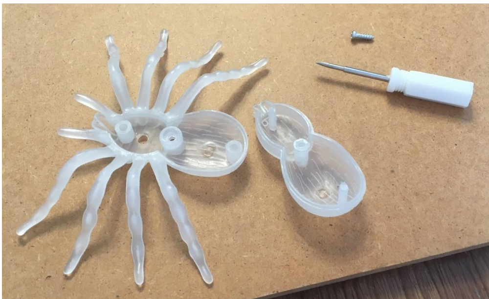
Boven: plastic glow in the dark- spinnetje ontleedt d.m.v. het losmaken van 1 schroef die in de spin zat (zie gat in de torso van het onderste deel).
